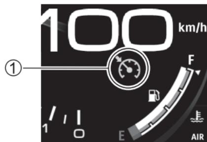
2. Drücken Sie bei eingeschalteter Geschwindigkeitsregler-Anzeige ① den TEMPOMAT-Schalter **SET/-** ② am linken Lenkerschalter, nachdem Sie die eingestellte Geschwindigkeit erreicht haben, um die Geschwindigkeit des Tempomats so einzustellen, dass die aktuelle Geschwindigkeit auch nach dem Lockern des Gasgriffs beibehalten wird.
