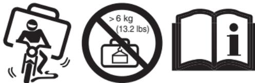
Überladen des Motorrads führt zu einer Verminderung der Fahrstabilität und kann einen Verlust der Kontrolle über das Fahrzeug verursachen.
