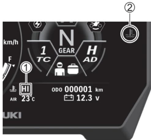
Wenn die Motorkühlmitteltemperatur-Warnanzeigeleuchte aufleuchtet, halten Sie das Motorrad an einer sicheren Stelle an, führen Sie die nachfolgenden Überprüfungen durch und ergreifen Sie die erforderlichen Maßnahmen.
