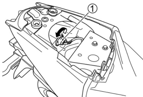
2. Drehen Sie die Fassung ① entgegen dem Uhrzeigersinn und nehmen Sie sie ab.
