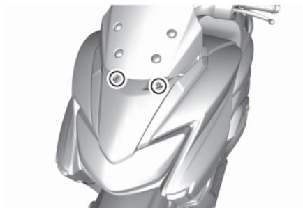
3. Lösen Sie die Haken und nehmen Sie den vorderen Beinschutz ① ab.
